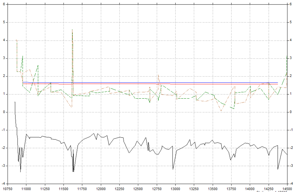
Figur 9 Beregnet vinter median maksimum vandstand; Blå linje angiver eksisterende forhold og rød linje angiver scenarie 2a
