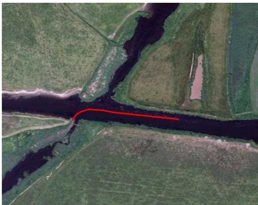
Fig. 4.1.3. Scenarie 2a - Princip for etablering af spuns
